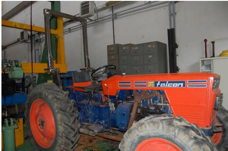
Figura 11. Struttura di protezione per trattori a ruote a carreggiata standard modello Same Falcon e simili
